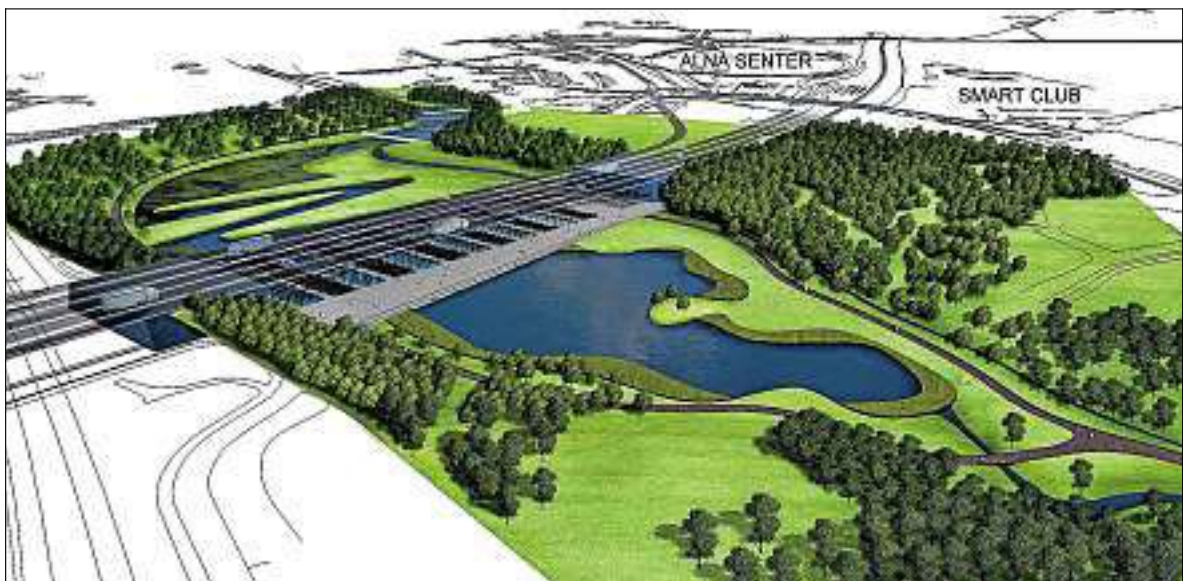
Vannrenseparken i fugleperspektiv. Terrenget er gravd ut for å gjøre plass til en vannrensepark på ca. 200 000 kvadratmeter (Vigelandsanlegget er ca. 450 000 kvadrat). Fem nye broer utgjør 10 veifiler med et spenn på 203 meter. Parken vil kunne rense mesteparten av vannet ved bruk av planter, og samtidig sende stagnert luft ut til Oslofjorden.
